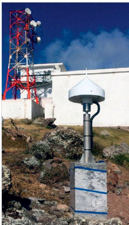
Рис. 4. Одна из опорных точек геодезической сети Метеорологического института Королевства Нидерланды на островах Карибского моря
