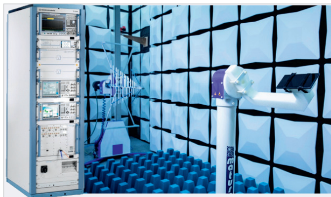
Рис. 3. Внешний вид тестовой системы R&S TS8996, обеспечивающей проведение испытаний устройств 2G/3G/4G/5G/WLAN/BT
