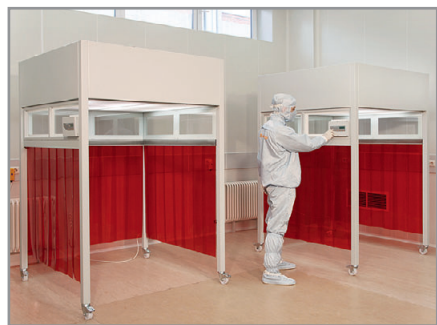
Рис. 1. Размеры каждой чистой зоны в сборе 1300 × 1300 × 1995 мм
