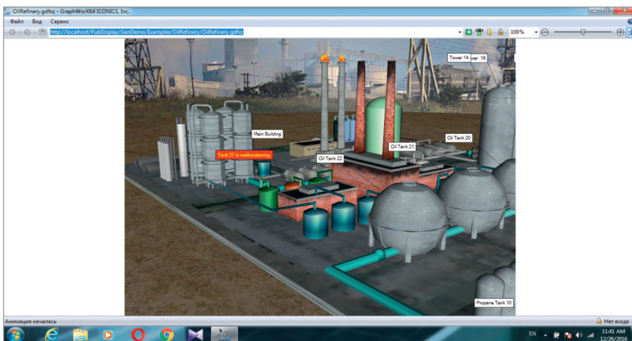
Рис. 7. Визуализация средствами ПО ICONICS GENESIS64 GraphWorX64
