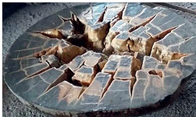
Рис. 9. Иллюстрация расщепления минерального состава камня под воздействием СВЧ
