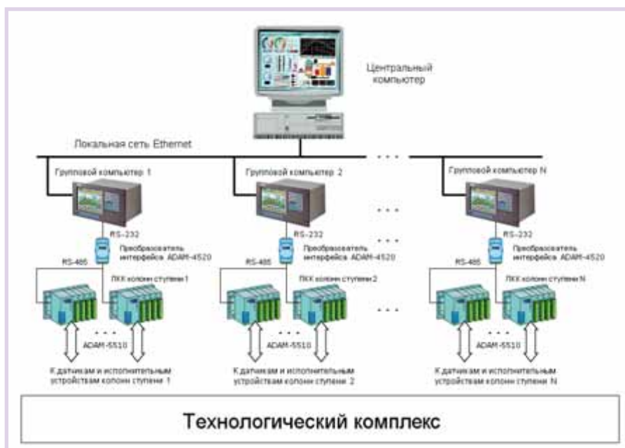
Рис. 7. Структура АСУ ТП многоступенчатого каскада
