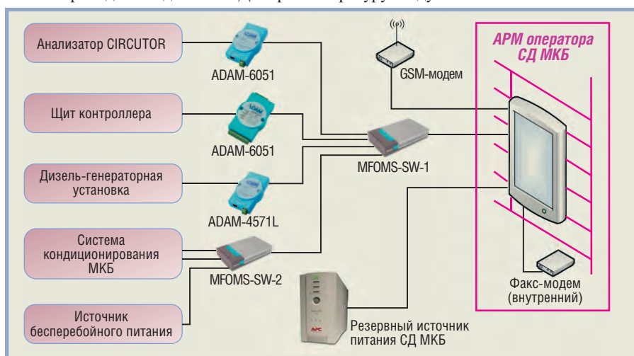
Рис. 2. Структурная схема сети организации диспетчеризации ЦОД
