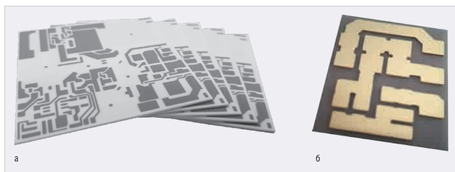
Рис. 4. Металлизация, выполненная по технологии Thick-Film (а) и DBC/STC (б)
