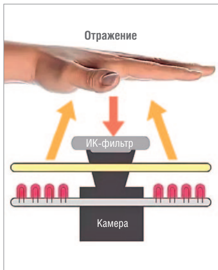
Рис. 3. Принцип работы сканера рисунка вен ладони
