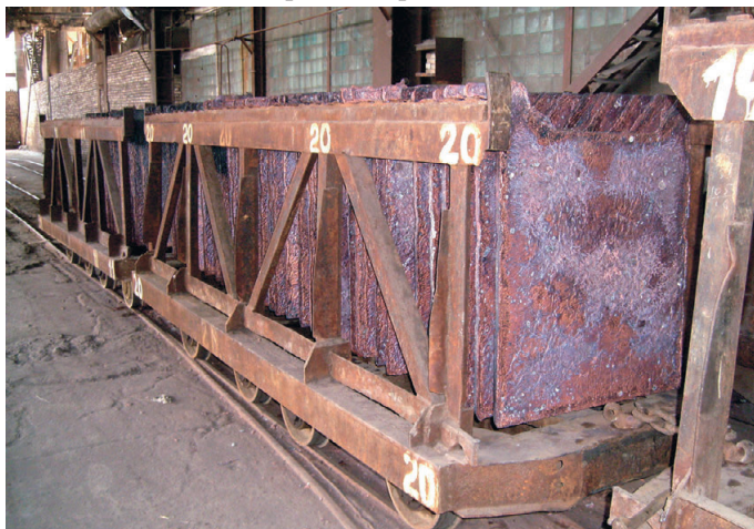
Рис. 6. Готовые аноды направляются в цех электролиза
