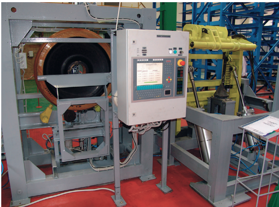
Рис. 3. Установка входного контроля параметров колёс
