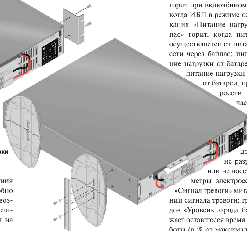
Рис. 3. Установка опор для напольного размещения ИБП
