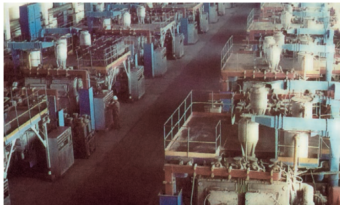
Рис. 3. Цех по производству порошка электролитического циркония
