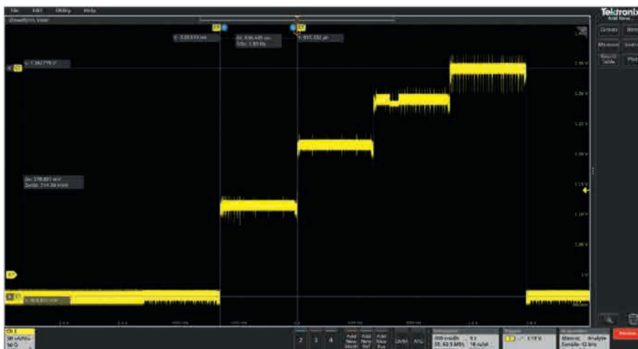
Рис. 8. Пример устройства, изменяющего входное напряжение с ростом частоты. Сигналы с частотой примерно 2 Гц, возникающие между шагами, будут подавлены большинством фильтров со связью по переменному току
