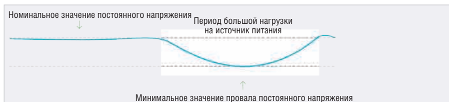
Рис. 7. Осциллограмма. Изменения нагрузки могут породить низкочастотные провалы напряжения в цепях питания. Связь по переменному току подавляет такие низкочастотные изменения
