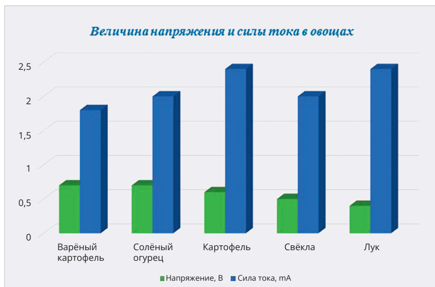
Рис. 13. Сведения о разных значениях выявленного напряжения и естественных биоразлагаемых источниках тока
