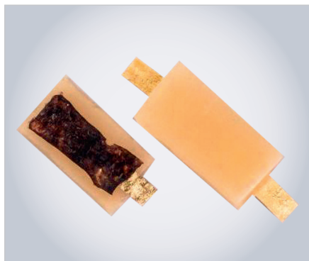
Рис. 1. Готовая к употреблению биоразлагаемая батарея производства Instituto Italiano di Tecnologia
