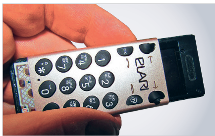
Рис. 12. Сотовый телефон Elari с АКБ энергоёмкостью 100 мА·ч
