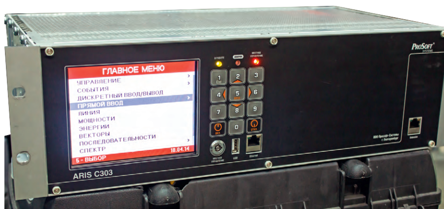
Рис. 1. Внешний вид контроллера ARIS C303
