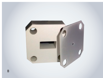
Рис. 1. Объёмный прямоугольный резонатор: эскиз конструкции (а), резонатор с установленной вдоль узкой стенки диэлектрической структурой (б), резонатор с элементами связи (в)
