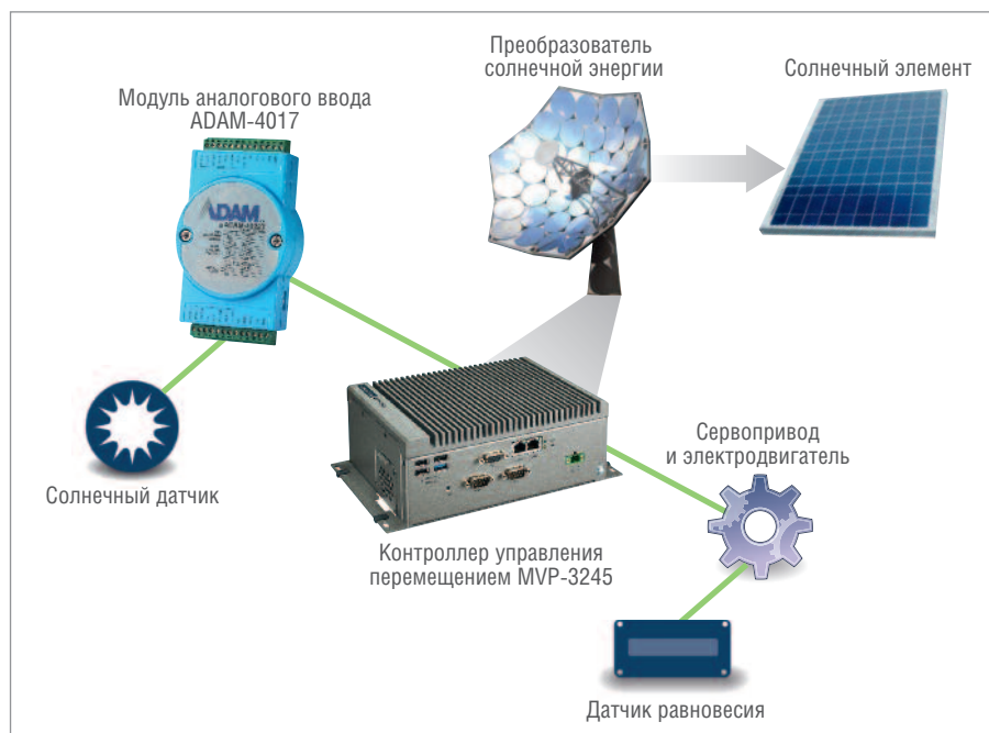
Рис. 4. Структура системы управления положением гелиоконцентратора
