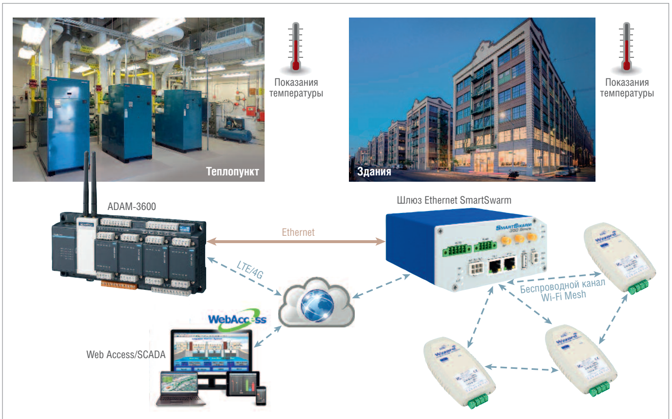
Рис. 2. Структура распределённой системы управления отоплением жилых массивов
