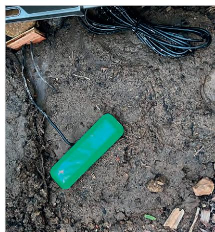
Рис. 9. Элемент питания в земле
