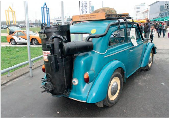
Рис. 2. Автомобиль с газогенераторной установкой
