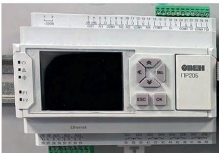
Рис. 1. Внешний вид программируемого реле ПР205
