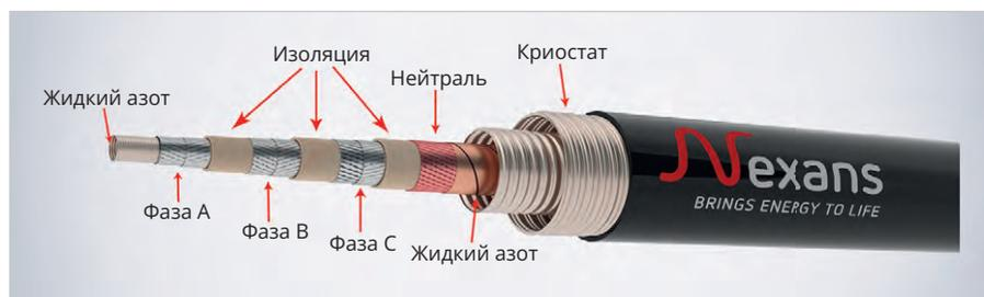
Рис. 6. Конструкция высокотемпературного сверхпроводящего кабеля фирмы Nexans
