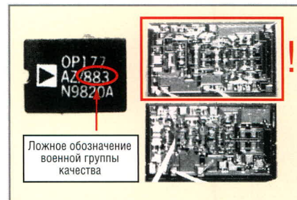
Рис. 3. Различие топологии кристаллов микросхемы OP177/883
