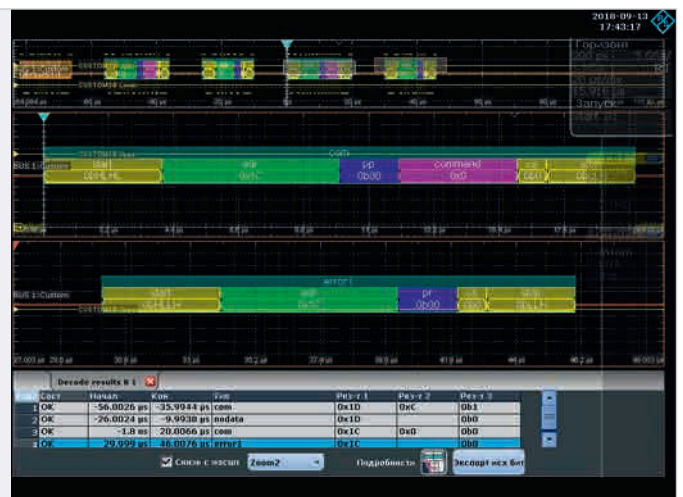
Рис. 8. Результаты декодирования последовательности запросов контроллера и ответов датчиков для пользовательского протокола: а) в NRZ-коде; б) в манчестерском коде
