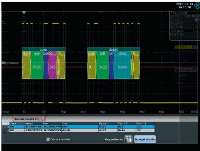
Рис. 7. Результаты декодирования MC запроса COM и передачи данных DATA0 : а) для NRZ-кодирования; б) для манчестерского кодирования
