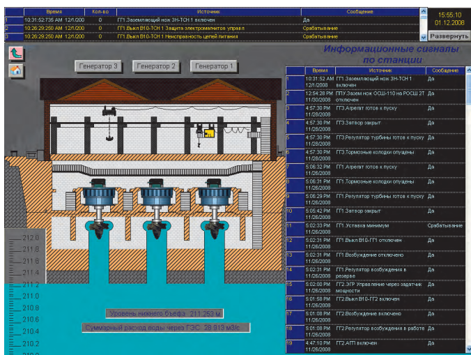
Рис. 6. Общая мнемосхема трёх генераторов с информационными сигналами
