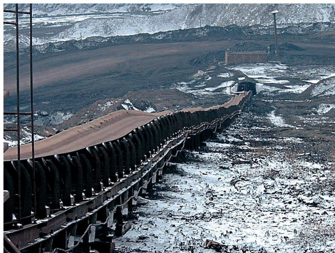
Рис. 10. Конвейер типа КРУ-350 для транспортировки угля с нижнего бункера на дробильно-сортировочный комплекс
