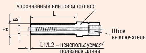
Рис. 17. Упрочнённый индуктивный датчик NJ0.2-10GM-N со встроенным механическим стопором
