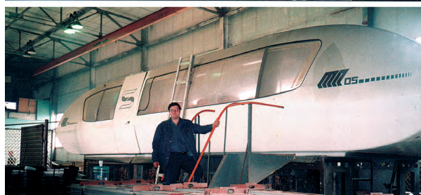
Стенд-вагоны различных модификаций в помещении монтажно-испытательного корпуса
