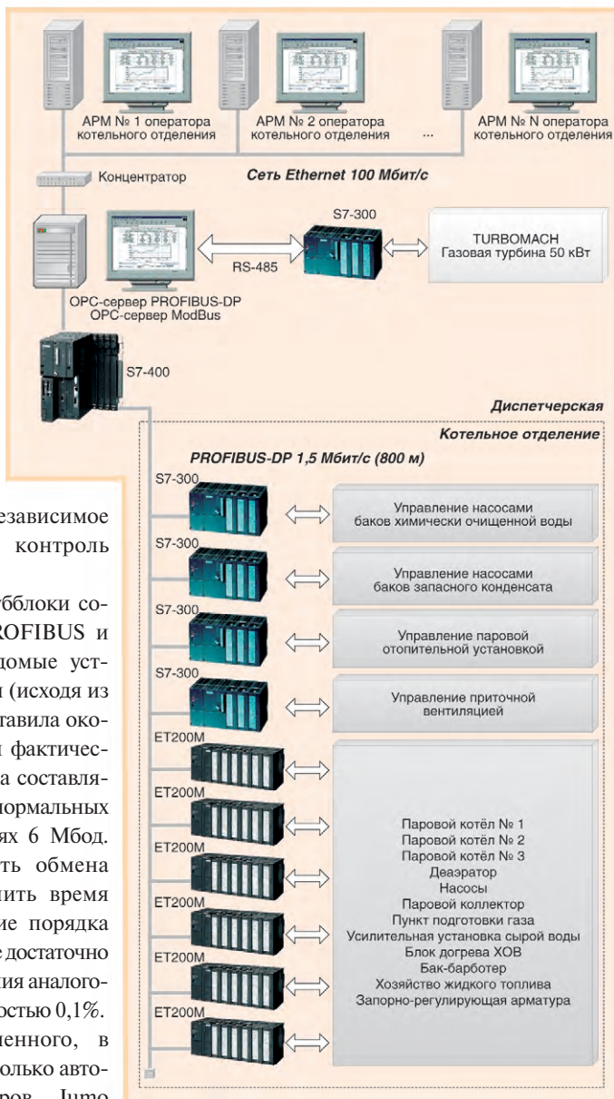
Рис. 1. Структурная схема КТС системы управления ТЭС «Балтика»
