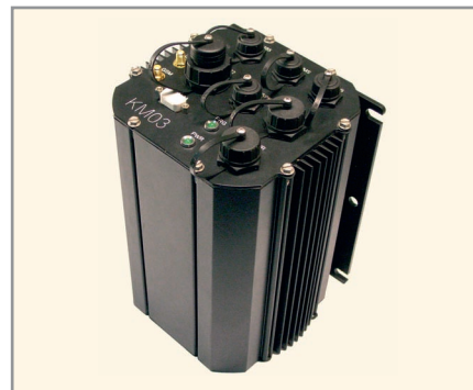
Рис. 11. Защищённые заказные компьютеры серии МК (Fastwel, Россия) на базе стека модулей PC/104 или StackPC с применением бюджетных корпусов фирмы Tri-M (Канада)
