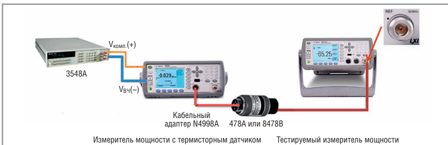
Рис. 2. Типовая схема измерений эталонной мощности 1 мВт 50 МГц [2]
