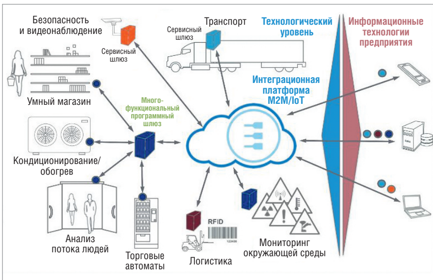
Рис. 3. Компания Eurotech построила решение ESB для устройств, позволяющее различным корпоративным приложениям работать с любыми M2M-источниками данных
