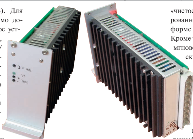
Рис. 2. Блок питания Schaefer серии C1300 (CP1300): вид сзади и вид спереди
