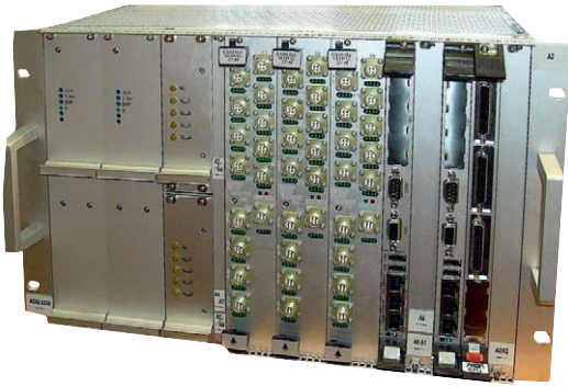
Рис. 17. Активный монтажный каркас для приборов в морском исполнении компании «Си Проект»
