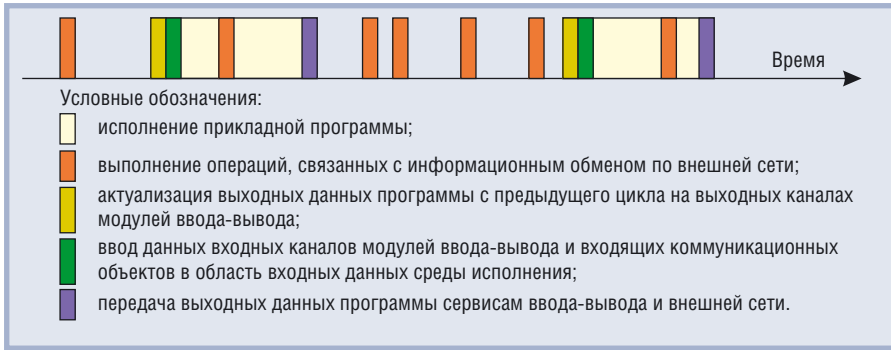
Рис. 2. Циклограмма исполнения прикладной программы
