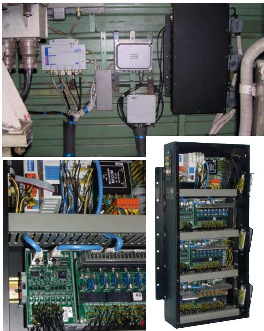
Рис. 5. Внешний вид модульного контроллера и специализированных модулей ввода-вывода для системы ЕКС-2 электровоза ЧС7
