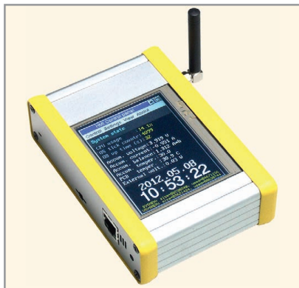
Рис. 3. Дисплей пользовательского интерфейса «M2M ассистент»
