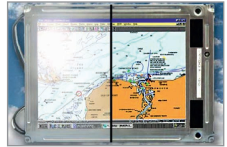
Рис. 2. Эффект применения технологии AOT Optical Bonding
