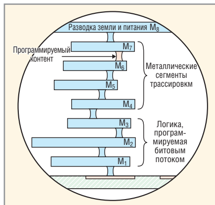
Рис. 12. Заказной слой межслойного перехода
