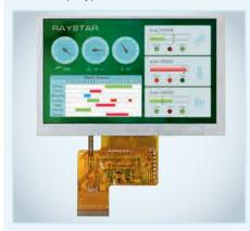
Дисплейный модуль с разрешением 800×480 пикселей выполнен по технологии IPS (In Plane Switching), которая обеспечивает широкий угол обзора. Функции управления ТFТ-модулем осуществляют встроенные микросхемы драйверов HX8249-A и HX8678-C.
