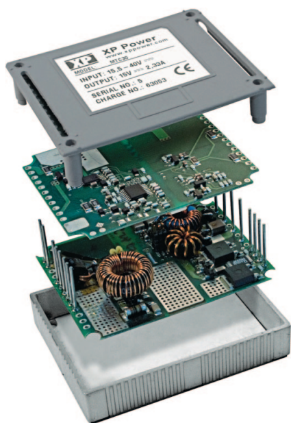
Рис. 1. Типичный COTS-преобразователь (модуль серии MTC компании XP Power), выполненный с использованием «этажерки» из печатных плат
