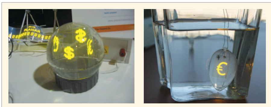
Рис. 14. Прототипы прозрачных ЭЛ-дисплеев, демонстрирующие их пространственную конструкцию
