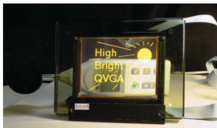
Рис. 8. Внешний вид прозрачного электролюминесцентного дисплея QVGA
