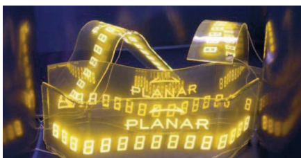
Рис. 13. Демонстрация изогнутого прозрачного электролюминесцентного дисплея
