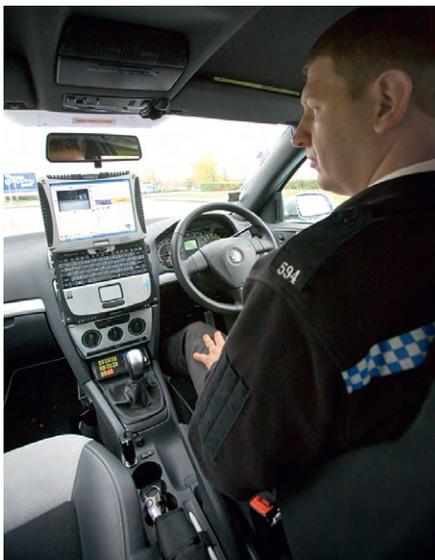
Рис. 1. Ноутбук CF-19 на док-станции в полицейском автомобиле
