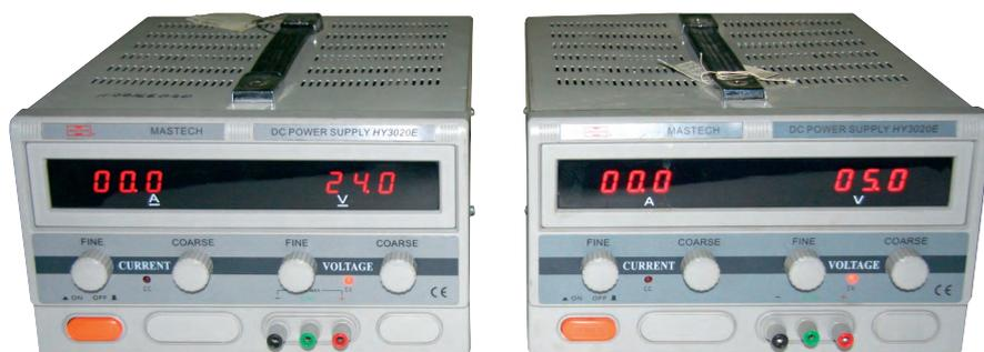
Рис. 7. Блоки питания постоянного тока напряжением 5 и 24 В
