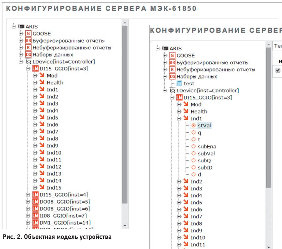
Рис. 2. Объектная модель устройства
