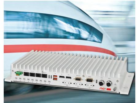
BL50W предназначен для работы при температуре  $-40...+85^{\circ}\text{C}$  и разработан в соответствии с EN 50155 для использования на железных дорогах. ●
