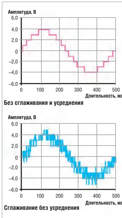
Рис. 21. Эффекты размывания и усреднения синусоидального сигнала
