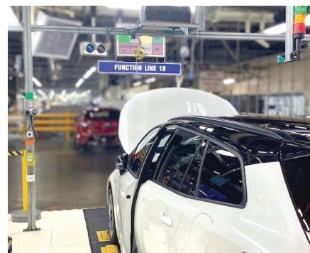
Рис. 4. Сигнальная лампа показывает, находится ли испытательная процедура в оптимальных временных рамках
