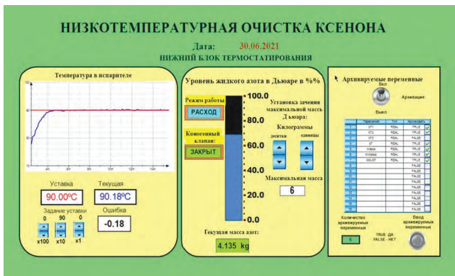
Рис. 5. Экран визуализации текущей температуры в испарителе, уровня жидкого азота и списка архивируемых переменных
