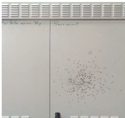
Рис. 14. Передняя сторона модульного уличного шкафа после обстрела: ни одна стальная гранула не пробила наружную стенку
