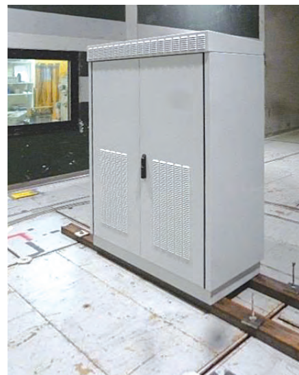
Рис. 11. Модульный шкаф в ветровом туннеле
