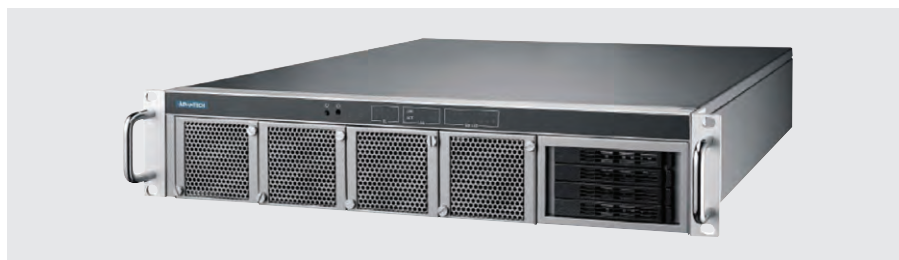
Рис. 5. Надёжный и компактный сервер Advantech ECU-570, сертифицированный по стандарту IEC 61850, можно настроить в качестве сервера-гипервизора системы автоматизации подстанции
