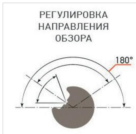
Рис. 9. Иллюстрация изменения угла обзора
