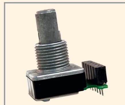
Расстояние с задней стороны панели для энкодера 62SG составляет всего 7,5 мм, что делает это изделие идеальным для применения в компактных устройствах. Также этот энкодер имеет самое маленькое посадочное место (12,7 × 14,7 мм) по сравнению с другими оптическими энкодерами Grayhill. Несмотря на компактные размеры энкодера и элементов в его конструкции, выходной сигнал очень чёткий.
