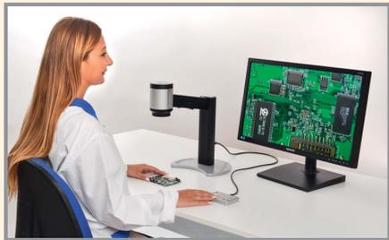
Inspectis C12 разработан на базе цифровой камеры высокого разрешения (Sony, 1/3" CMOS, ~1,4 МПикс) и предназначен для визуальной инспекции и контроля качества электронных модулей и фотошаблонов, инспекции изделий машиностроения, используется при диагностических и ремонтных работах, монтаже компонентов и пр.
