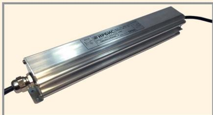
Конструктивно выполнен в алюминиевом корпусе и залит теплопроводным компаундом. При работе предполагает пассивное охлаждение за счёт естественной конвекции. Допускает внешние воздействия по классу IP66. Соответствует требованиям ТУ 6390-121-40039437-11.
