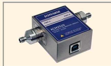
температур +18...+28°C используется термокомпенсация. Диапазон рабочих частот составляет от 100 кГц до 20 ГГц, размеры – 106,4 × 55 × 28 мм, вес 435 г.
