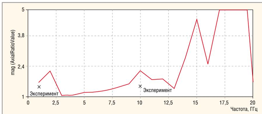
Рис. 9. Осевое отношение логоспиральной антенны в диапазоне частот 1...20 ГГц
