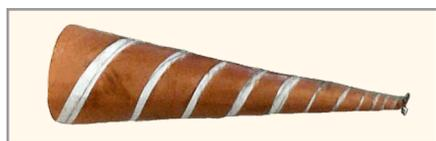
**Рис. 6. Макет логоспиральной антенны**
