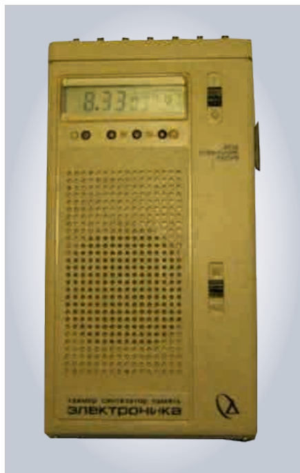
Рис. 10. Первый отечественный супергетеродин на интегральных схемах с цифровым управлением «Электроника 16-21»
