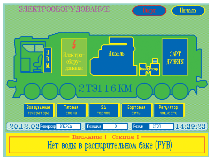
Рис. 12. Меню диагностических панелей с отображением аварийного сообщения
