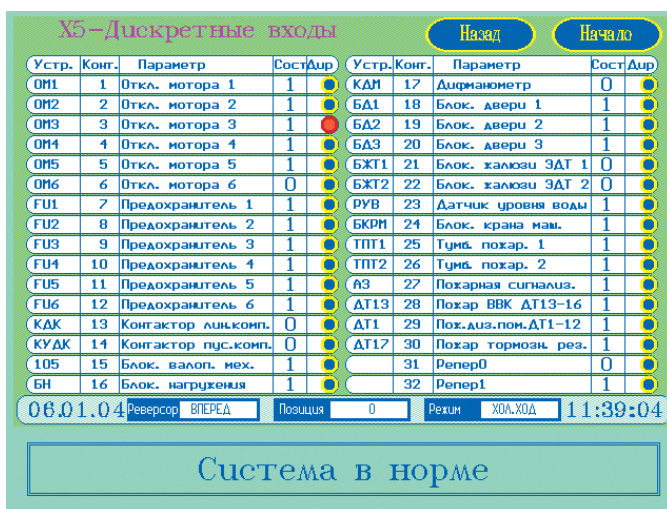
Рис. 14. Панель дискретных входов в разъёме X5
