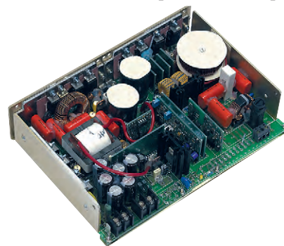
Рис. 2. Внешний вид конструкции DC/AC-преобразователя DAX200-245L1-C (кожух снят)
