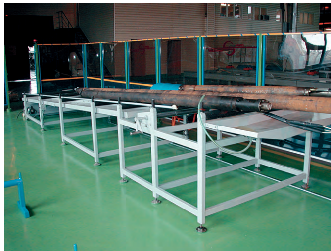
Рис. 7. Станина стенда тестирования ПЭД
