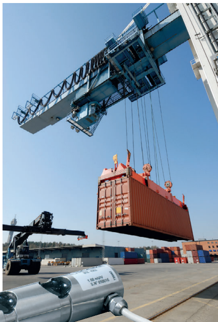
Рис. 8. Датчик силы на кране
