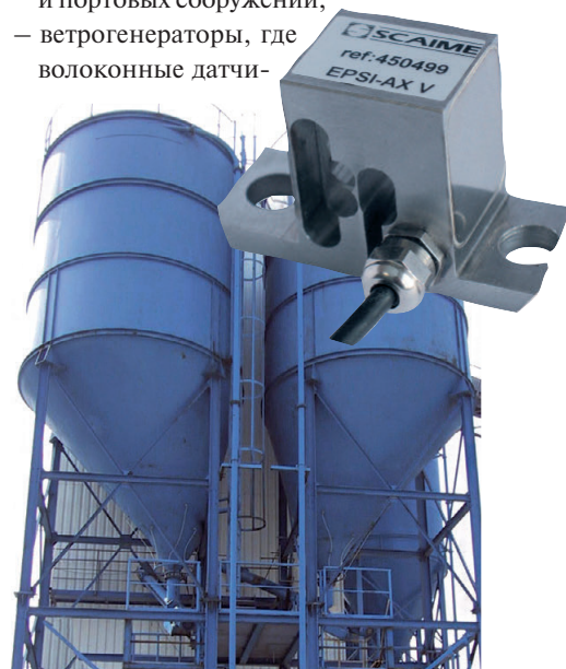
Рис. 9. Контроль деформаций опор бункера
