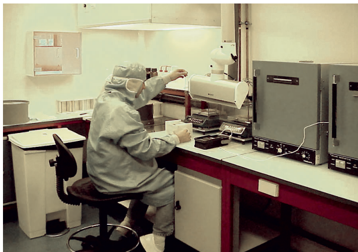
Рис. 3. «Чистая» комната для производства тензомостов
