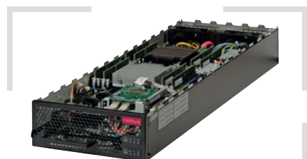
Рис. 5. Компоновка и охлаждение вычислительного модуля OCP
