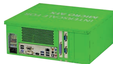
Рис. 18. Компьютерный корпус Interscale M для системной платы формата Micro ATX
