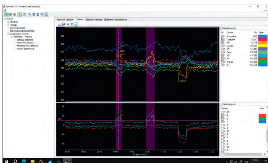
Рис. 7. Графики показаний расходомеров без калибровки
