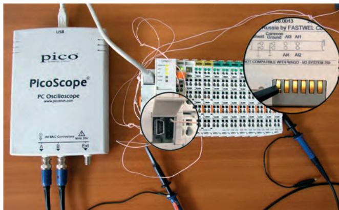
Рис. 19. Подключение осциллографа к контроллеру для получения циклограмм исполнения прикладной программы и обмена с модулями по внутренней шине
