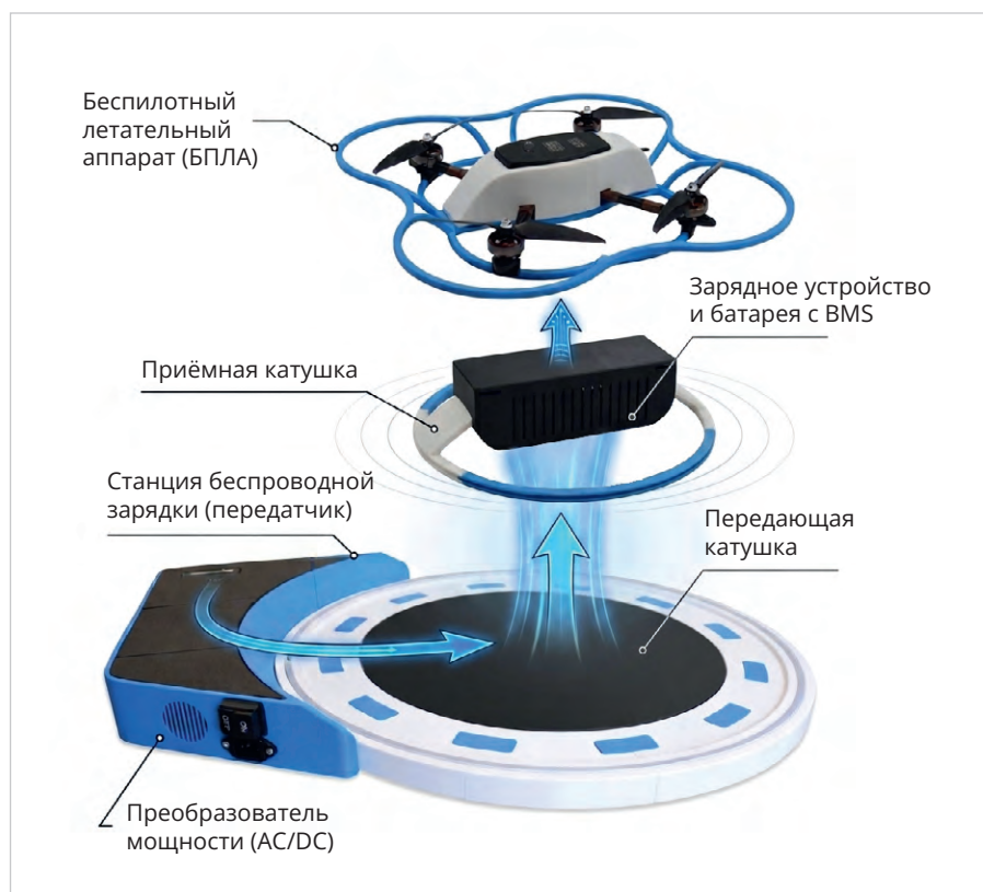
Рис. 12. Общий вид системы беспроводной передачи энергии
