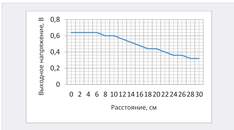
Рис. 9. Передаваемое напряжение в зависимости от вертикального расстояния, центры совмещены
