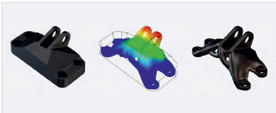
Рис. 15. Моделирование элементов конструкций шкафов с помощью ПО, «оптимизирующего» напряжённо-деформированное состояние решётчатых структур
