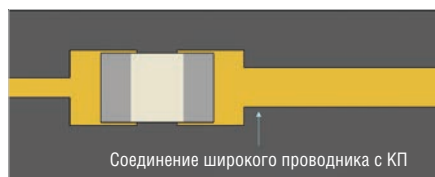
Рис. 6. Подключение широкого проводника к силовой контактной площадке
