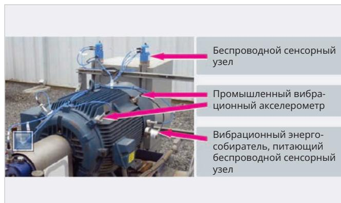
Рис. 5. Пример расположения сенсорных IoT-устройств
