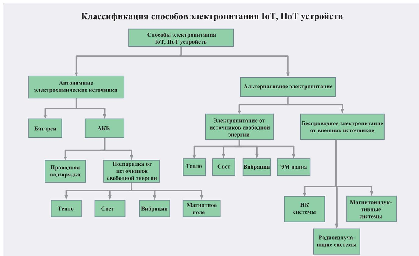
Рис. 1. Классификация способов электропитания IoT-устройств
