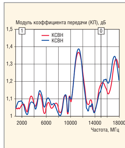
Рис. 4. Частотная зависимость КСВН выхода двухуровневого генератора шума типа TGN2G15S при низком уровне ENR
