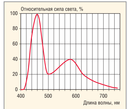
Рис. 8. Спектральная характеристика светодиодов BT5050WC-XX-P180
