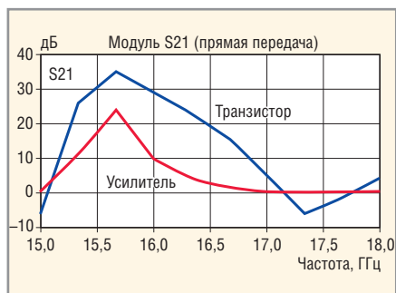
Рис. 6. Частотные характеристики отдельного транзистора и волноводного усилителя, созданном на этом транзисторе
