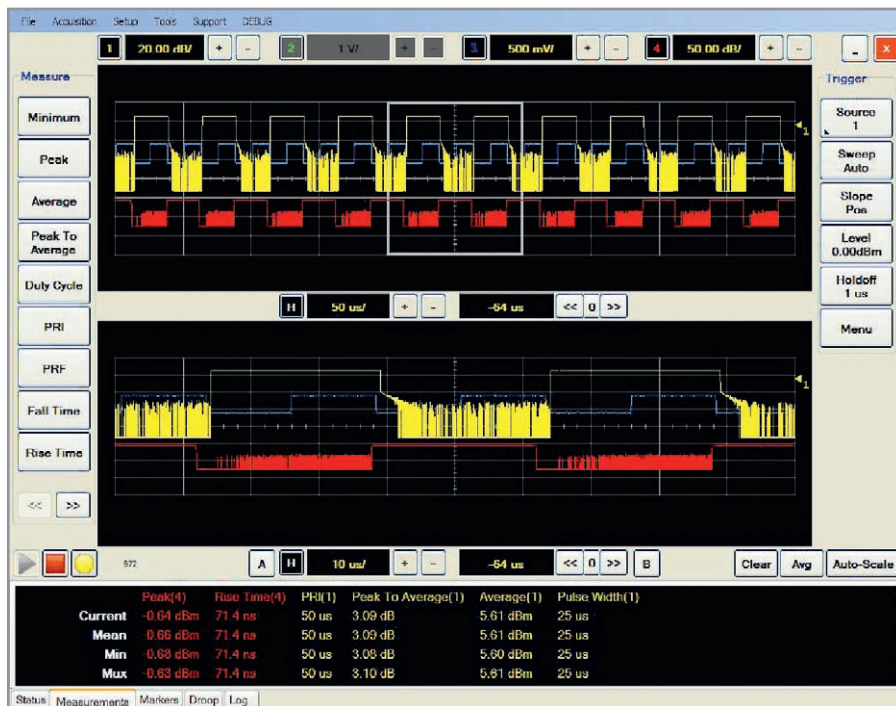
Рис. 4. Расположенные одно над другим окна позволяют одновременно анализировать последовательности импульсов или получать более детальное представление отдельных импульсов
