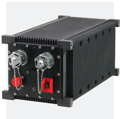
Рис. 8. Шасси для MMC стандарта VPX с кондуктивным охлаждением для установки на борт носителя
