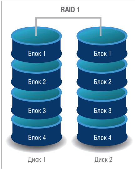
Рис. 1. Зеркалирование дисков при RAID 1
