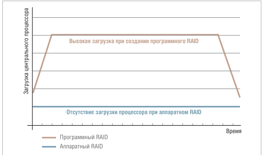
Рис. 2. График загрузки центрального процессора для аппаратного и программного RAID
