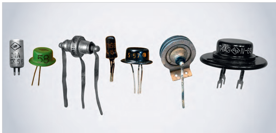
Рис. 1. Первые советские транзисторы из коллекции автора статьи, слева направо: точечные – С1, С3; плоскостные – П1, П5, П6 и мощные – П3, П4
