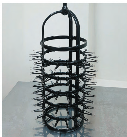
для электрохимического никелирования и золочения в серийном режиме
