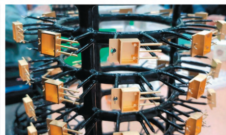
Основания металлокерамических и металlostеклянных корпусов с гальваническим золотым покрытием
