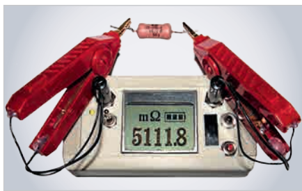
Рис. 8. Измерения на первом диапазоне. Резистор 5,11 Ом, 1% (C2-29B-1)
