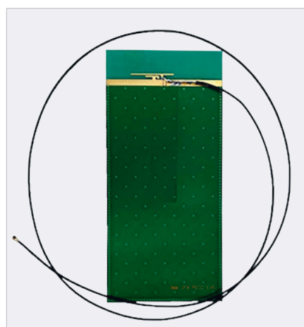
Рис. 11. Подключение в виде элемента антенны участка коаксиального кабеля длиной 700 мм
