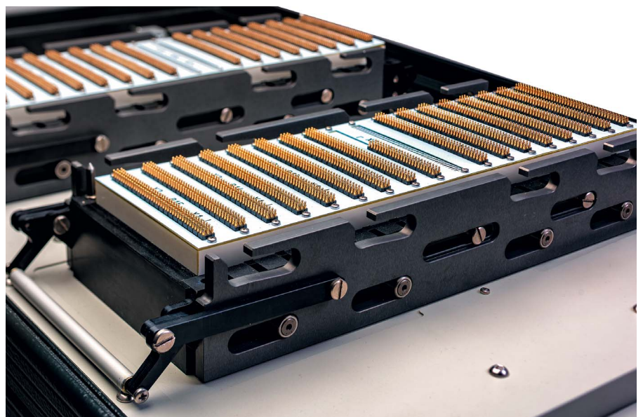
Рис. 5. Прецизионное прижимное устройство измерительного блока
