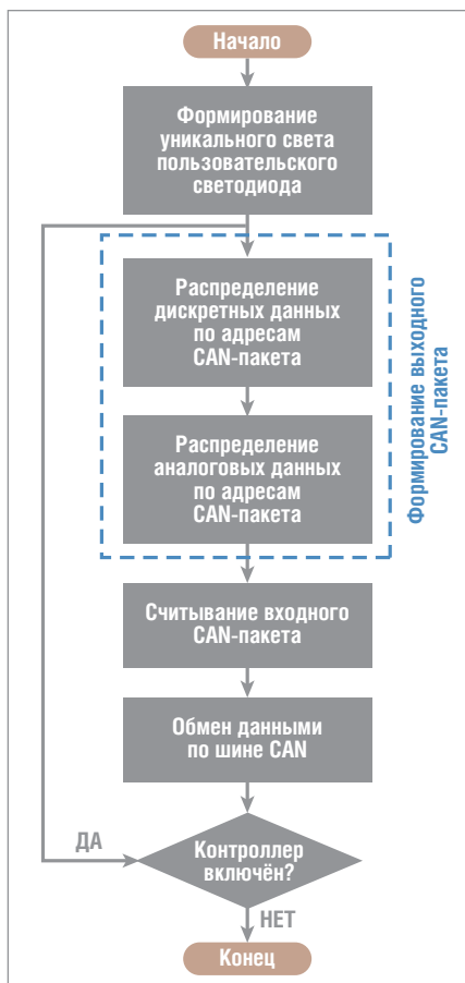
Рис. 6. Схема алгоритма программы нижнего уровня
