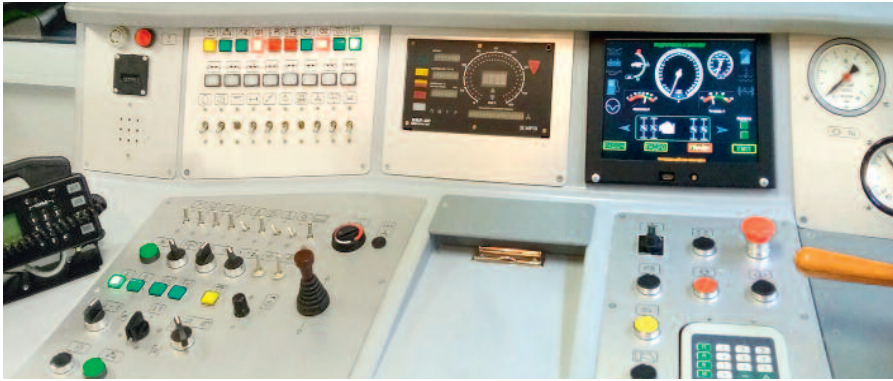
Рис. 3. Дисплей системы мониторинга и управления на рабочем месте машиниста путевой машины
