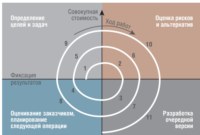
Рис. 2. Спиральная модель жизненного цикла программного комплекса бортовой системы мониторинга и управления
